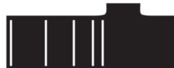
LÍNEAS AUXILIARES PARA REDUCCIÓN DE VELOCIDAD (Distribución logarítmica)
