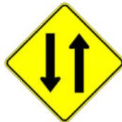
INICIO DE DOBLE CIRCULACIÓN
