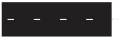
LÍNEA DE SEPARACIÓN DE SENTIDO DE CIRCULACIÓN (Indica la posibilidad de ser traspasada)
