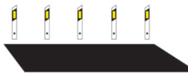
DELINEADORES (Canalizan o guían el tránsito y destacan variaciones en la vía)
